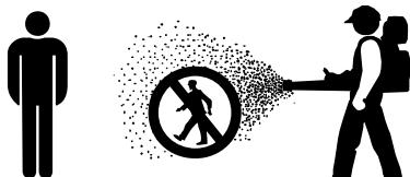
Запрещается направлять нагнетательную трубу на других людей – устройство может отбрасывать небольшие предметы с большой скоростью – **опасность получения травм!**
