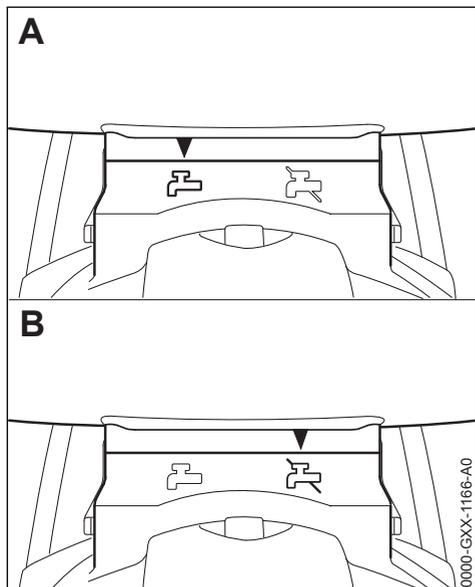
Заданный режим эксплуатации отображается посредством символа на корпусе дозирующего устройства.
