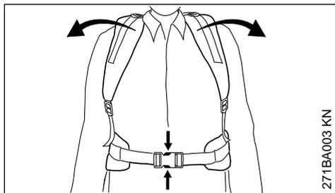
На случай аварийной ситуации: потренировать быстрое открывание замка на набедренном поясе (специальная принадлежность), освобождение наплечных лямок и снятие устройства со спины. При тренировке не бросать устройство на землю во избежание повреждений.
