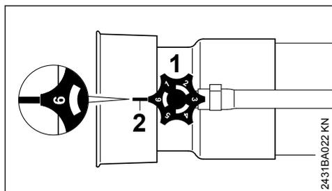
► Повернуть дозатор (1) – подача регулируется плавно
