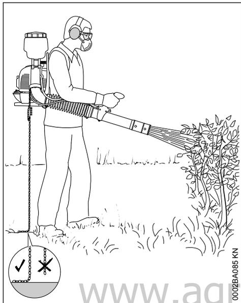
Для снижения риска образования искр с опасностью взрыва или пожара на устройстве должна быть смонтирована комплектная система разрядки. Она состоит из токопроводящего провода в системе воздухоудки, который соединен с металлической цепью. Для отвода электростатических зарядов металлическая цепь должна касаться токопроводящего пола.
