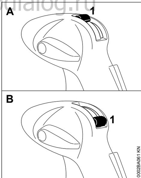
Рычаг клапана (1) служит для включения и выключения подачи раствора.
