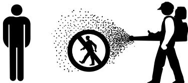
Запрещается направлять нагнетательную трубу на других людей – устройство может отбрасывать небольшие предметы с большой скоростью – **опасность получения травм!**
