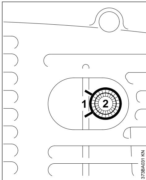
При падении мощности двигателя или нерегулярном числе оборотов проверьте искрозащитную решетку (имеется в зависимости от страны) в глушителе.
