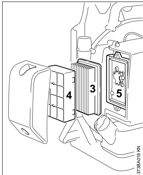
▶ Главный фильтр (3) вынуть из крышки фильтра и проверить – при наличии загрязнения либо повреждения заменить
