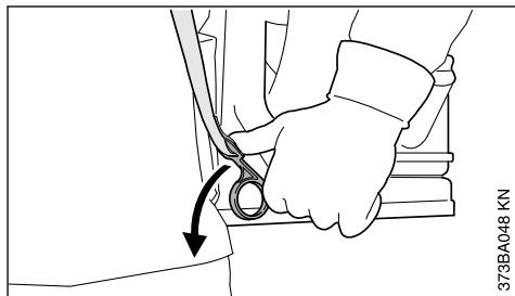
Перед эксплуатацией следует ознакомиться с быстрым снятием агрегата.
