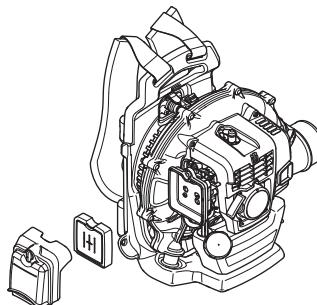
Воздушный фильтр после эксплуатации в течение некоторого времени невозможно полностью вычистить. Поэтому его нужно периодически менять на новый. Поврежденный воздушный фильтр необходимо заменить.
