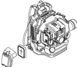
Воздушный фильтр после эксплуатации в течение некоторого времени невозможно полностью вычистить. Поэтому его нужно периодически менять на новый. Поврежденный воздушный фильтр необходимо заменить.
