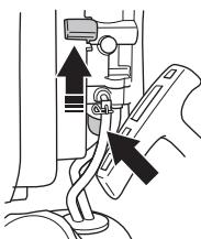
Топливный насос: Сожмите несколько раз резиновую грушу топливного насоса пока в нее не начнет поступать топливо. Груша нет необходимости заполнять полностью.
