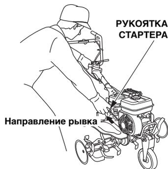
6. Дайте двигателю прогреться в течение несколько минут. Если во время пуска рычаг управления воздушной заслонкой стоял в положении CLOSED (Закртыо), то по мере прогрева двигателя постепенно переведите его в положение OPEN (Открыто).
