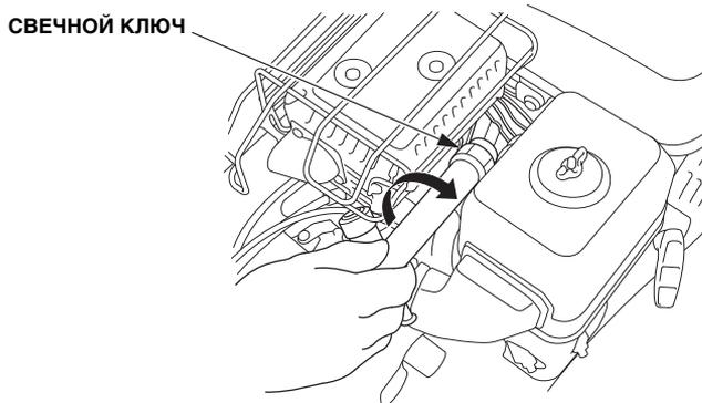
5. После установки свечи зажигания в резьбовое гнездо затяните ее свечным ключом, чтобы обжать уплотнительную шайбу.
