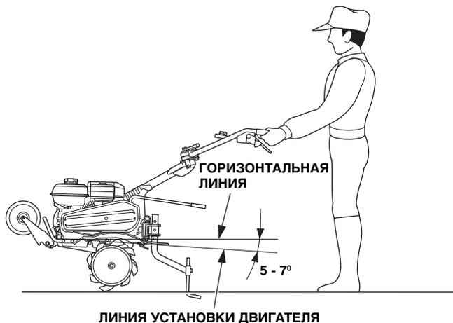
Для получения максимальной производительности мотокультиватора старайтесь при культивации почвы удерживать мотокультиватор под углом, показанным на рисунке.
