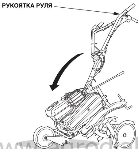
2. Возьмитесь за рукоятку и толкните ее в указанном стрелкой направлении для поднятия ближайшей фрезы с земли. Удерживайте в этом положении. Удерживая рукоятку, не тяните тросы. Наклоняя мотокультиватор, будьте внимательны. Если чрезмерно наклонить мотокультиватор, может протечь топливо.
