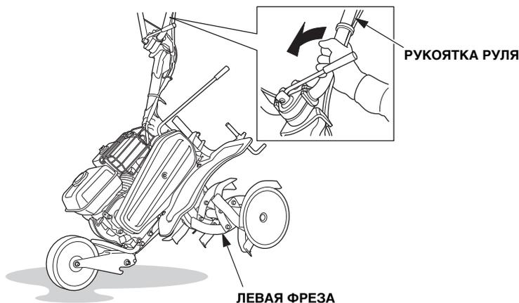
3. Снимите стопорные шплинты и оси фрез, затем снимите боковой диск и наружные фрезы.
