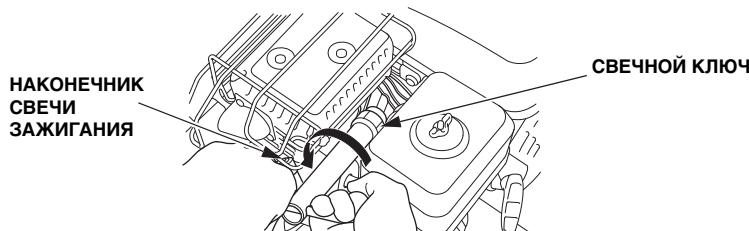
2. Визуально проверьте исправность свечи зажигания. Если изолятор свечи имеет трещины или сколы, свечу необходимо заменить. Если свеча зажигания будет снова установлена в двигатель, предварительно очистите ее с помощью проволочной щетки.
