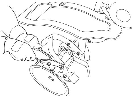
Перед началом работ по проверке или замене установите переднее колесо (модификация DER) в нижнее положение (см. стр. 34), поместите мотокультиватор на горизонтальную поверхность и зафиксируйте его. Переведите топливный кран в положение OFF (выкл.).
