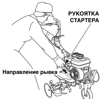
6. Дайте двигателю прогреться в течение нескольких минут. Если во время пуска рычаг управления воздушной заслонкой стоял в положении CLOSED (Закрыто), то по мере прогрева двигателя постепенно переводите его в положение OPEN (Открыто).
