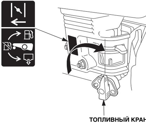
2. В холодную погоду и при пуске холодного двигателя переведите рычаг управления воздушной заслонкой в положение CLOSE (ЗАКРЫТО).
