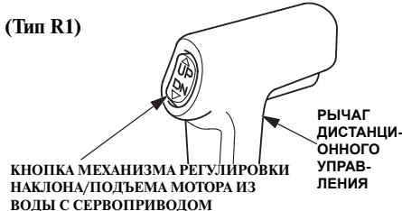
КНОПКА МЕХАНИЗМА РЕГУЛИРОВКИ НАКЛОНА/ПОДЪЕМА МОТОРА ИЗ ВОДЫ С СЕРВОПРИВОДОМ
