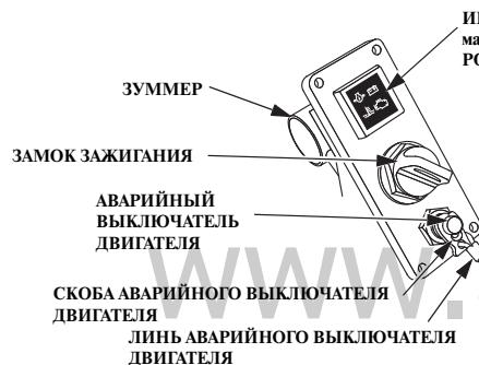
(для ДВУХМОТОРНОЙ СИЛОВОЙ УСТАНОВКИ)
