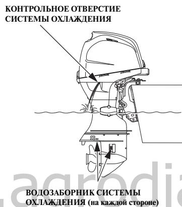
4. После пуска двигателя проверьте наличие водяной струи, вытекающей из контрольного отверстия. Расход воды, вытекающей из контрольного отверстия, может изменяться в зависимости от состояния термостата. Это является нормальным явлением.
