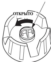
3. Чтобы открыть вентиляционный клапан крышки топливного бака, выверните его до упора против часовой стрелки.
