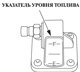
Указатель уровня топлива показывает уровень топлива в топливном баке.
