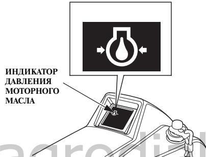
6. Проверьте состояние индикатора нормального давления масла: индикатор должен быть включен. Если индикатор выключен, остановите двигатель и выполните следующие действия.
