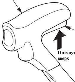
КНОПКА ФИКСАТОРА РЫЧАГА В НЕЙТРАЛЬНОМ ПОЛОЖЕНИИ
