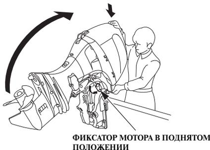
При швартовке поднимите подвесной мотор и закрепите его в поднятом положении с помощью рычага фиксатора. Переведите рычаг дистанционного управления в НЕЙТРАЛЬНОЕ положение и остановите двигатель перед началом подъема подвесного мотора.
