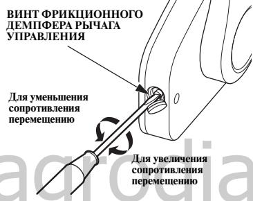
Проверьте плавность перемещения рычага дистанционного управления. Сопротивление перемещению рычага управления можно отрегулировать вращением винта фрикционного демпфера по или против часовой стрелки.
