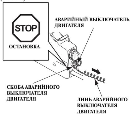
Для остановки двигателя в экстренных ситуациях потяните за аварийный линь и выдерните скобу из кнопки аварийного выключателя двигателя. Это приведет к выключению двигателя.
