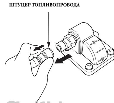
2. Сдвиньте муфту штуцера топливопровода и, потянув за штуцер, отсоедините топливопровод от топливного бака.
