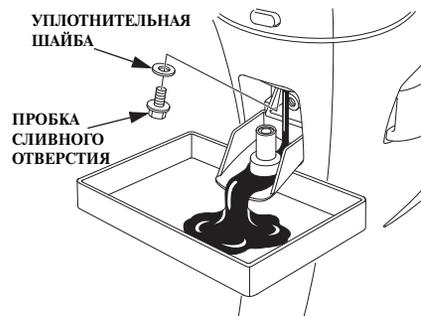
4. Выверните пробку сливного отверстия с помощью гаечного ключа на 12 мм, снимите шайбу и слейте моторное масло.
