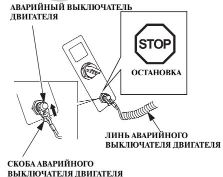
Запасная скоба аварийного выключателя двигателя (дополнительное оборудование)
