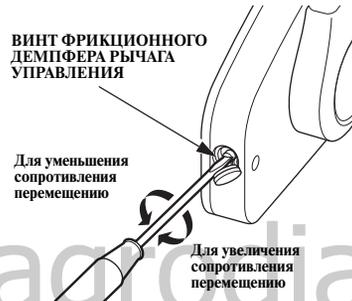
Проверьте плавность перемещения рычага дистанционного управления. Сопротивление перемещению рычага управления можно отрегулировать вращением винта фрикционного демпфера по или против часовой стрелки.
