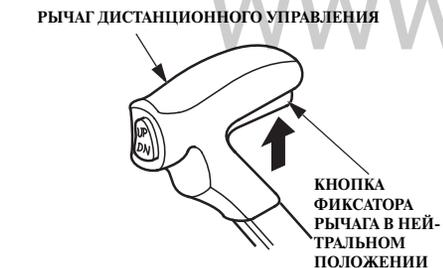
Кнопка фиксатора рычага в нейтральном положении предназначена для предотвращения случайного перемещения рычага.
