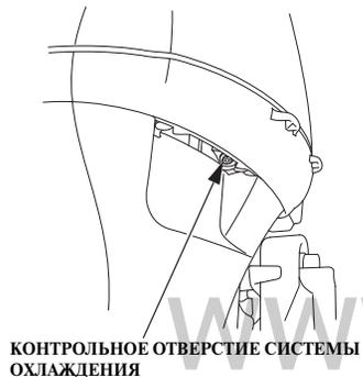
Контрольное отверстие служит для контроля нормальной циркуляции воды в системе охлаждения двигателя.
