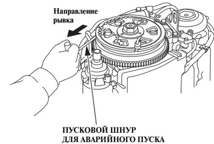
10. Слегка потяните ручку пускового шнура стартера до появления сопротивления, затем резко потяните в направлении, указанном стрелкой вниз.
