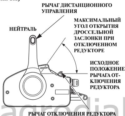
Осуществить перемещение рычага отключения редуктора невозможно до тех пор, пока рычаг дистанционного управления не установлен в нейтральное положение. И наоборот, рычаг дистанционного управления не будет перемещаться, если рычаг отключения редуктора не установлен в нижнее положение.
