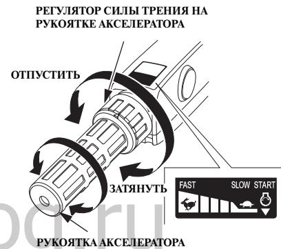
Регулятор силы трения на рукоятке акселератора служит для регулировки силы сопротивления вращению рукоятки.
