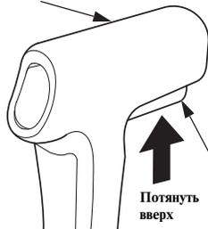
КНОПКА ФИКСАТОРА РЫЧАГА В НЕЙТРАЛЬНОМ ПОЛОЖЕНИИ
