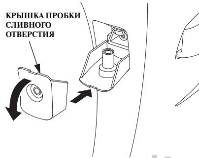
3. Поверните и установите снятую крышку, как показано на рисунке, для того чтобы использовать её в качестве удлинителя. Поместите под отверстие подходящую емкость.
