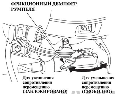
При транспортировке или перевозке судна с установленным подвесным мотором необходимо отсоединить топливопровод от переносного топливного бака и повернуть регулятор фрикционного демпфера румпеля в положение LOCK (заблокировано).
