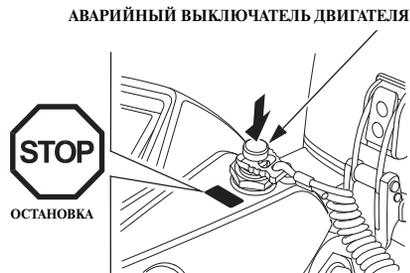
Для остановки двигателя нажмите на аварийный выключатель двигателя.
