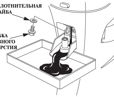
4. Выверните пробку сливного отверстия с помощью гаечного ключа на 12 мм, снимите шайбу и слейте моторное масло.
