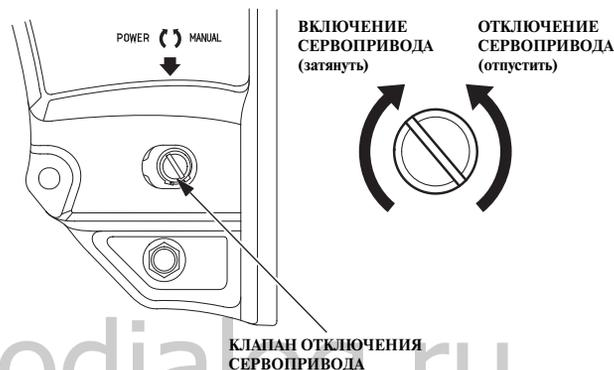
Если вам не удалось поднять мотор при помощи кнопки механизма регулировки наклона/подъема мотора из воды с сервоприводом, то, отключив сервопривод, вы сможете опустить или поднять мотор вручную. Для подъема подвешенного мотора вручную отверните с помощью отвертки клапан отключения сервопривода на два с половиной оборота (против часовой стрелки). Клапан расположен под транцевым кронштейном.
