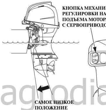
КНОПКА МЕХАНИЗМА РЕГУЛИРОВКИ НАКЛОНА/ ПОДЪЕМА МОТОРА ИЗ ВОДЫ С СЕРВОПРИВОДОМ
