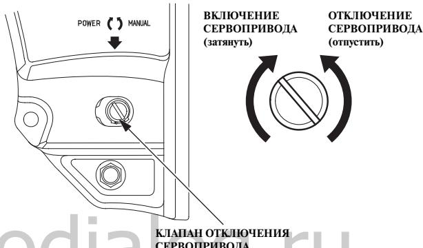
КЛАПАН ОТКЛЮЧЕНИЯ СЕРВОПРИВОДА
