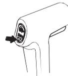
При максимальном угле наклона подвесного мотора индикация указателя наклона будет соответствовать изображению. Для того чтобы опустить нос судна, уменьшите наклон подвесного мотора. Для этого следует нажать кнопку DN (вниз) механизма регулировки наклона/подъема мотора из воды с сервоприводом.
