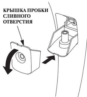
3. Поверните и установите снятую крышку, как показано на рисунке, для того чтобы использовать ее в качестве удлинителя. Поместите под отверстие подходящую емкость.
