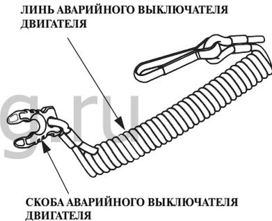
Линия аварийного выключателя двигателя предназначен для экстренной остановки двигателя при падении судоводителя за борт или в случае потери управления судном.
