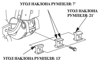
Установите высоту регулировочного блока таким образом, чтобы выбранный угол наклона румпеля находился в этом положении.
