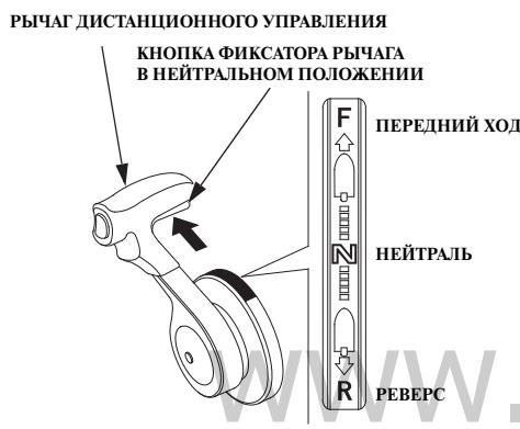
Рычаг дистанционного управления предназначен для переключения передач переднего хода, реверса и нейтрали и управления частотой вращения коленчатого вала двигателя. Для того чтобы вывести рычаг дистанционного управления из нейтрального положения необходимо нажать на кнопку фиксатора вверх.
