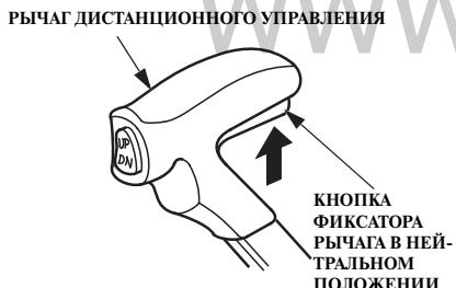
Кнопка фиксатора рычага в нейтральном положении предназначена для предотвращения случайного перемещения рычага.
