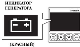
При неисправности системы электрооборудования включается индикатор генератора и подается звуковой сигнал зуммера.
