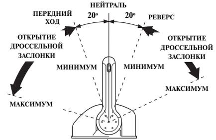
Рычаг дистанционного управления предназначен для переключения передач переднего хода, реверса и нейтрали и управления частотой вращения коленчатого вала двигателя.
