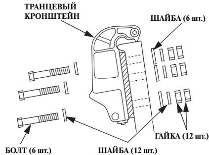
1. Заложите силиконовый герметик (Three Bond 1216 или аналогичный ему) в крепежные отверстия мотора.
