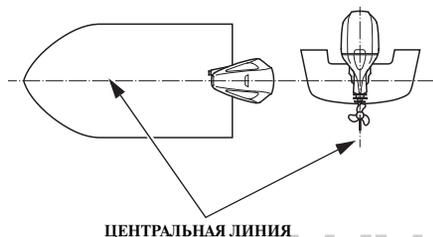
Установите подвесной мотор на корме строго по центральной линии маломерного судна.
