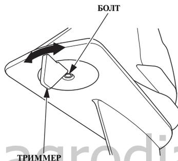
Если на максимальной скорости движения штурвал или румпель тянет в сторону, отрегулируйте положение триммера так, чтобы судно шло прямым курсом. Отпустите крепежный болт и поверните перо триммера влево или вправо, чтобы избавиться от увода.
