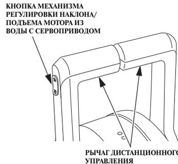
ПАНЕЛЬ КНОПОК МЕХАНИЗМА
