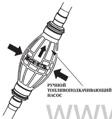
Возьмите в руку грушу топливоподкачивающего насоса, так чтобы напорная линия располагалась выше всасывающей (стрелка на груше должна быть направлена вверх). Подкачивайте топливо до ощутимого возрастания сопротивления сжатию груши (это будет свидетельствовать о том, что топливо достигло двигателя). Убедитесь в отсутствии утечки.
