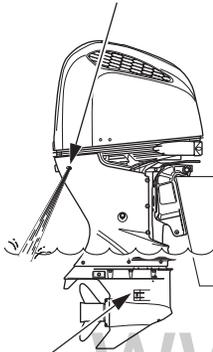
ВОДОЗАБОРНИК СИСТЕМЫ ОХЛАЖДЕНИЯ (на каждой стороне)
