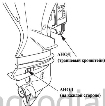
Разрушающийся материал анодов обеспечивает противокоррозионную защиту подвесного мотора.
