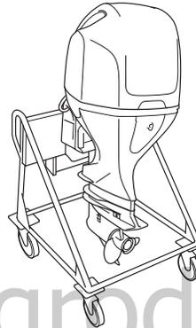
Перевозите и храните подвесной мотор в вертикальном положении, как показано на рисунке. Установите транцевый кронштейн мотора на вертикальную панель стойки и закрепите мотор с помощью болтов и гаек. Храните подвесной мотор в хорошо проветриваемом сухом помещении. Не подвергайте подвесной мотор прямому воздействию солнечных лучей.
