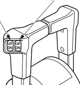
ПАНЕЛЬ КНОПОК МЕХАНИЗМА РЕГУЛИРОВКИ НАКЛОНА/ПОДЪЕМА МОТОРА ИЗ ВОДЫ С СЕРВОПРИВОДОМ
