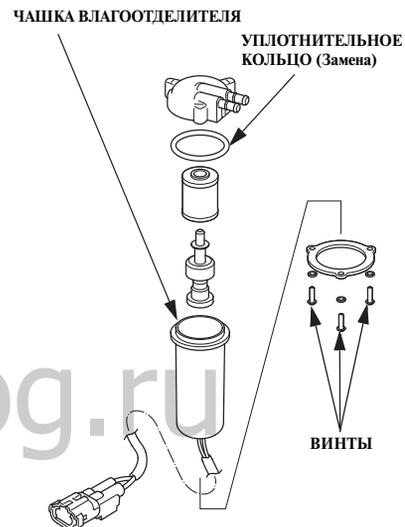
5. Отверните три винта, крепящие топливный фильтр с влагоотделителем, удалите воду или отстой из чашки.
