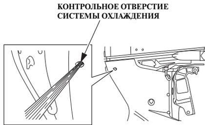
Контрольное отверстие служит для контроля нормальной циркуляции воды в системе охлаждения двигателя.
