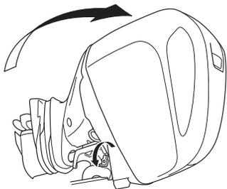
При швартовке поднимите подвесной мотор и закрепите его в поднятом положении с помощью рычага фиксатора. Переведите рычаг дистанционного управления в НЕЙТРАЛЬНОЕ положение и заглушите двигатель перед началом подъема подвесного мотора.
