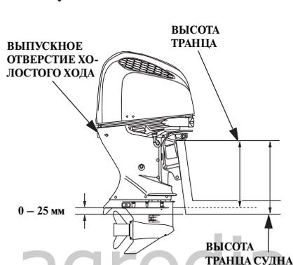
Проверьте, чтобы высота транца судна соответствовала длине дейдвуда подвесного мотора. Неправильное положение по высоте снизит эффективность подвесного мотора. Подвесной мотор должен быть установлен так, чтобы антикавитационная плита располагалась выше плоскости днища судна на 0 – 25 мм. Высота дейдвуда зависит от назначения судна и типа его корпуса. Придерживайтесь рекомендаций завода-изготовителя судна.
