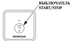
ОДНОВРЕМЕННЫЙ ПУСК ВСЕХ ДВИГАТЕЛЕЙ ДЛЯ ДВУХ- И ТРЕХМОТОРНОЙ СИЛОВОЙ УСТАНОВКИ
