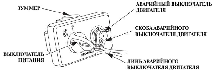
(с механическим ключом без выключателя START/STOP) (горизонтального типа)
