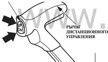
При необходимости регулировки датчика ограничения угла наклона мотора обращайтесь к официальному дилеру компании Honda. Нажимая на кнопки UP (ВВЕРХ) и DN (ВНИЗ) механизма регулировки наклона/подъема мотора из воды с сервоприводом, установите оптимальный угол наклона мотора, который соответствует условиям движения судна.
