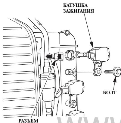
3. Нажав на защелку, отсоедините разъем от катушки зажигания. Тяните за пластиковый разъем, но не за провода.
