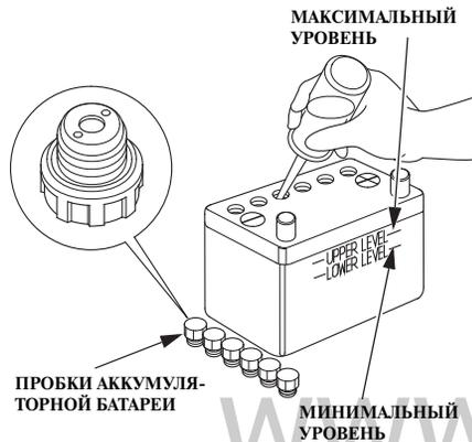
3. Долейте в аккумуляторную батарею дистиллированную воду и доведите уровень электролита до верхней метки. Запрещается превышать максимальный уровень электролита.
