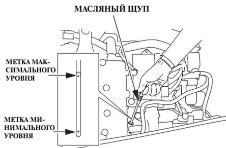
4. Заправьте систему смазки двигателя рекомендуемым моторным маслом и доведите уровень масла до верхней метки на масляном щупе.
