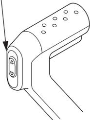
КНОПКА МЕХАНИЗМА РЕГУЛИРОВКИ НАКЛОНА/ПОДЪЕМА МОТОРА ИЗ ВОДЫ С СЕРВОПРИВОДОМ
