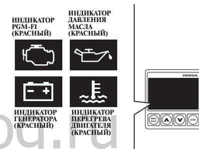
При перегреве двигателя через 20 секунд после срабатывания системы защиты двигателя и понижения частоты вращения двигателя двигатель автоматически остановится. Каждая из систем защиты двигателя (PGM-FI, генератора переменного тока, перегрева двигателя, водоотделителя) активизируется в результате условий, указанных в приведенной ниже таблице.
