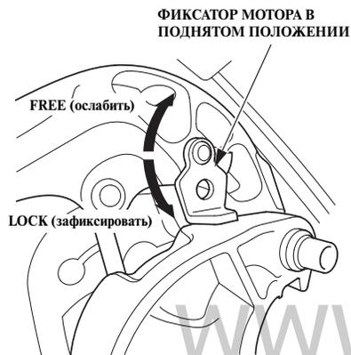
При длительной стоянке судна у причала или на якоре зафиксируйте подвесной мотор в поднятом положении с помощью рычага.
