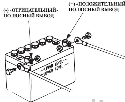
3. Присоедините клемму красного провода к «положительному» полюсному выводу батареи (+), затем присоедините клемму черного провода к «отрицательному» полюсному выводу батареи (-). Надежно затяните болты и гайки. Нанесите на клеммы и выводы аккумуляторной батареи защитную пластичную смазку.
