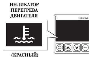
При неисправности системы охлаждения двигателя включается индикатор перегрева двигателя и подается звуковой сигнал зуммера. При этом происходит уменьшение частоты вращения двигателя.
