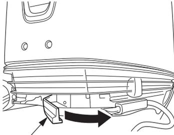
ЗАМОК КОЖУХА ДВИГАТЕЛЯ
