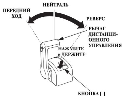
Используйте кнопку [-] и рычаг дистанционного управления для прогрева двигателя на более высоких оборотах без включения редуктора.
