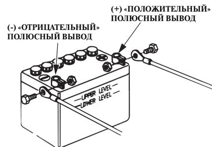
1. Отсоедините клемму от «отрицательного» полюсного вывода (-), затем от «положительного» полюсного вывода (+).
