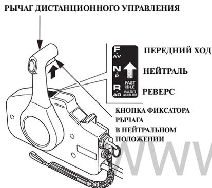
Рычаг дистанционного управления предназначен для переключения передач переднего хода, реверса и нейтрали и управления частотой вращения коленчатого вала двигателя.
