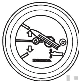
Указатель показывает угол наклона мотора в диапазоне от -4° до 16°. Изменяя угол наклона мотора для улучшения ходовых качеств судна, контролируйте изменения угла при помощи указателя угла наклона.
