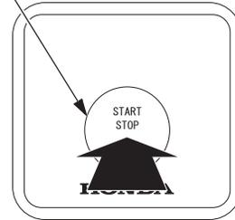
2. Нажмите выключатель START/STOP, чтобы остановить двигатель.
