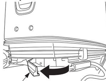
ЗАМОК КОЖУХА ДВИГАТЕЛЯ
