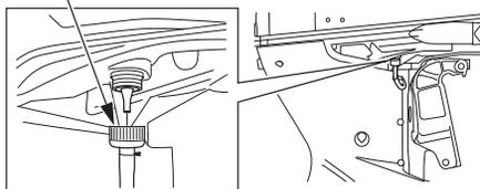
4. Выньте заглушку промывочного отверстия на подвесном моторе.
