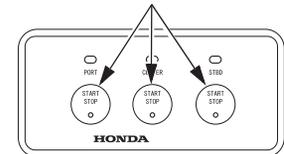
ТРЕХМОТОРНАЯ СИЛОВАЯ УСТАНОВКА
