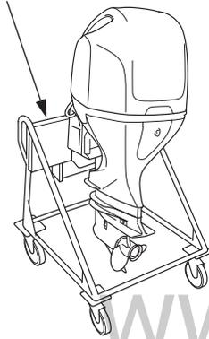
3. Закрепите подвесной мотор на стойке с помощью крепежных болтов и гаек.
