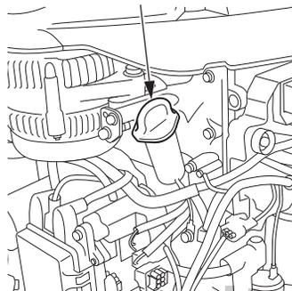
5. Установите на место крышку маслозаливной горловины. Не затягивайте крышку слишком сильно.
