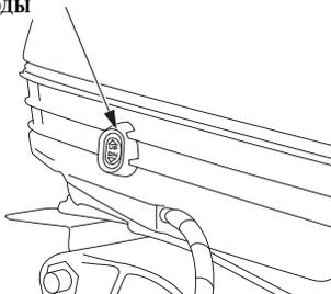
Если вы находитесь на удалении от поста дистанционного управления и не можете воспользоваться органами управления, расположенными на нем, то поднять подвесной мотор можно при помощи органа управления системы подъема подвесного мотора, который находится сбоку на подвесном моторе. Процесс управления подъемом мотора при помощи этой системы аналогичен подъему мотора при помощи органов управления, расположенных на посту дистанционного управления.
