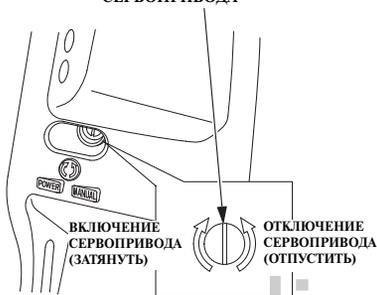
Если сервопривод механизма регулировки наклона/подъема мотора из воды не функционирует (например, из-за разряженной аккумуляторной батареи или неисправного электродвигателя сервопривода), то подвесной мотор можно поднять или опустить вручную. Для этого необходимо отключить сервопривод.
