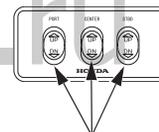
КНОПКА МЕХАНИЗМА РЕГУЛИРОВКИ НАКЛОНА/ПОДЪЕМА МОТОРА ИЗ ВОДЫ С СЕРВОПРИВОДОМ
