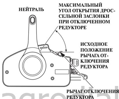
Осуществить перемещение рычага отключения редуктора невозможно до тех пор, пока рычаг дистанционного управления не установлен в нейтральное положение. И наоборот, рычаг дистанционного управления не будет перемещаться, если рычаг отключения редуктора не установлен в нижнее положение.
