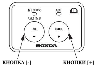
Функциональные кнопки используются в режиме отключения редуктора и в режиме троллинга.
