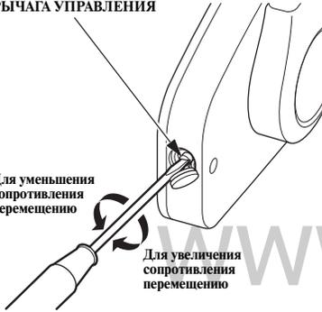
Проверьте плавность перемещения рычага дистанционного управления. Сопротивление перемещению рычага дистанционного управления можно отрегулировать вращением винта фрикционного демпфера по или против часовой стрелки.
