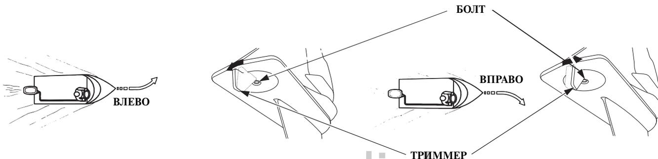
Триммер предназначен для компенсации неуравновешенного момента, который обусловлен вращением гребного винта или крутящим моментом гребного винта. Если при повороте судна на высокой скорости усилия, прилагаемые к штурвалу или румпелю, несимметричны при повороте налево и направо, то необходимо установить триммер таким образом, чтобы усилия на штурвале или румпеле при повороте в любую сторону были одинаковы.
