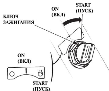
3. Поверните ключ зажигания в положение START (ПУСК) для пуска двигателя. Сразу после пуска двигателя отпустите ключ зажигания. Отпущенный ключ зажигания вернется в положение ON (ВКЛ).
