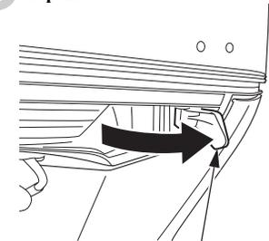
Отстегните замки кожуха двигателя, затем снимите кожух.
