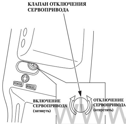
Если вам не удалось поднять мотор при помощи кнопки механизма регулировки наклона/подъема мотора из воды с сервоприводом, то, отключив сервопривод, вы сможете опустить или поднять мотор вручную. Для того чтобы поднять мотор вручную, при помощи отвертки поверните (против часовой стрелки) на 1-2 оборота (не более) клапан отключения сервопривода. Клапан отключения сервопривода расположен под левым транцевым кронштейном.
