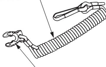
Скоба должна быть вставлена под кнопку аварийного выключателя двигателя. В противном случае пуск двигателя будет невозможен. При снятии скобы с аварийного выключателя двигатель автоматически останавливается.
