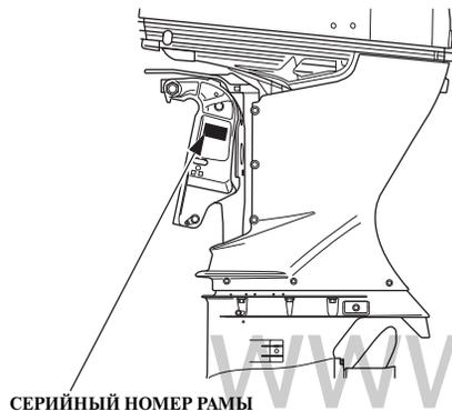
Запишите серийные номера рамы и двигателя. Указывайте серийные номера при заказе запасных частей, а также при обращениях по техническим и гарантийным вопросам.
