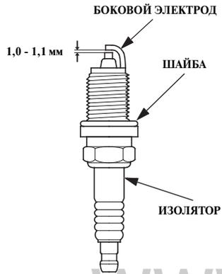
7. Измерьте с помощью плоского шупа зазор между электродами свечей зажигания. При необходимости отрегулируйте величину зазора, осторожно подгибая боковой электрод. Зазор между электродами свечи зажигания должен составлять: 1,0 - 1,1 мм
