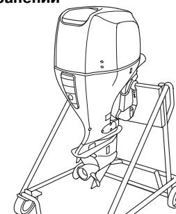
Перевозите и храните подвесной мотор в вертикальном или горизонтальном положении, как показано на рисунках. Прикрепите транцевый кронштейн к подмоторной стойке и закрепите подвесной мотор болтами с гайками. Храните подвесной мотор в хорошо проветриваемом сухом помещении, и предохраняя от воздействия прямых солнечных лучей.
