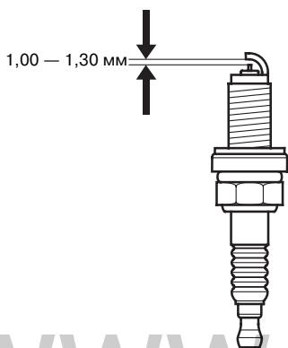
11. Измерьте с помощью плоского щупа зазор между электродами свечей зажигания. Величина зазора должна составлять 1,00 — 1,30 мм. Если величина зазора не соответствует техническим условиям, то замените свечу. Не предпринимайте попыток отрегулировать величину зазора.
