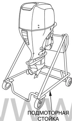
3. Закрепите подвесной мотор на стойке с помощью болтов и гаек.
