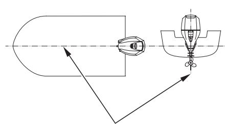
Установите подвесной мотор на корме в диаметральной плоскости лодки.
