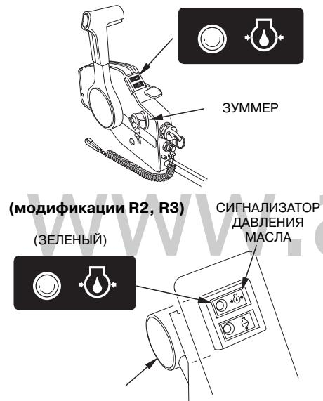
При низком уровне масла и/или неисправности системы смазки двигателя выключается индикатор нормального давления моторного масла и включается зуммер. При этом происходит плавное уменьшение частоты вращения вала двигателя.
