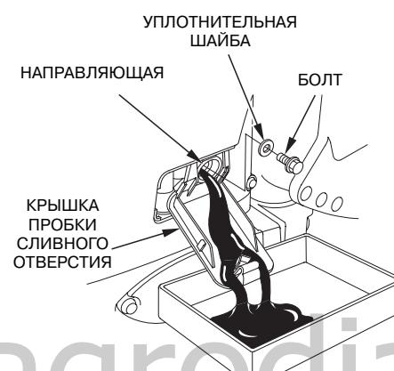
Установите новую шайбу, вверните и плотно затяните сливную пробку.
