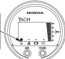
5. Проверьте состояние индикатора нормального давления масла: индикатор должен быть включен.
