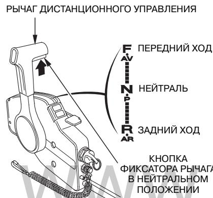
Рычаг дистанционного управления предназначен для переключения муфты реверса (передний и задний ход, нейтраль) и управления частотой вращения вала двигателя. Для того чтобы вывести рычаг дистанционного управления из нейтрального положения необходимо нажать на клавишу фиксатора.
