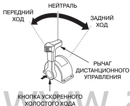
Кнопка ускоренного холостого хода и рычаг управления используются для сокращения периода прогрева двигателя без включения муфты реверса. Нажав на кнопку ускоренного холостого хода, сдвиньте рычаг дистанционного управления вперёд. Продолжайте сдвигать рычаг вперёд. После того как рычаг минует положение включения муфты гребного вала обороты двигателя начнут увеличиваться.
