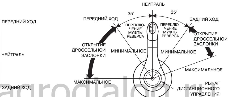
При перемещении рычага в положение ПЕРЕДНИЙ ХОД (примерно на угол 30 градусов вперед от нейтрального положения) включается передача переднего хода.
