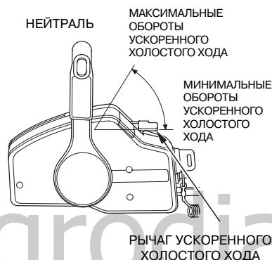
Рычаг ускоренного холостого хода не перемещается, если рычаг дистанционного управления не установлен в положение "НЕЙТРАЛЬ". Рычаг дистанционного управления не будет разблокирован пока рычаг укоренного холостого хода не будет переведён в положение минимальных оборотов.
