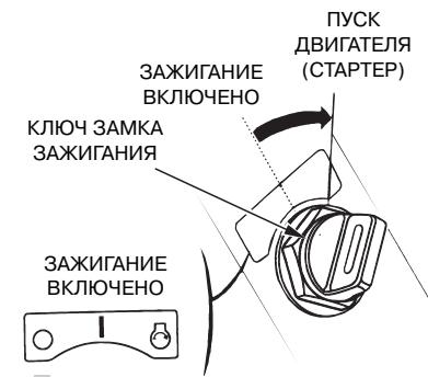
3. Поверните ключ в положение START (СТАРТЕР), для того чтобы пустить двигатель. Как только двигатель заработает, отпустите ключ зажигания.
