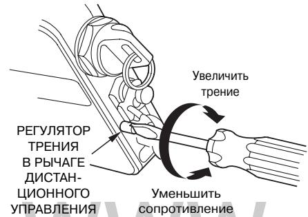
Проверьте плавность перемещения рычага дистанционного управления. Сопротивление перемещению рычага можно отрегулировать вращением регулировочного винта фрикционного затвора по или против часовой стрелки.
