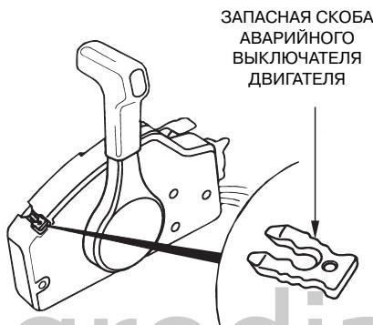
Запасная чека аварийного выключателя двигателя находится в гнезде на блоке дистанционного управления
