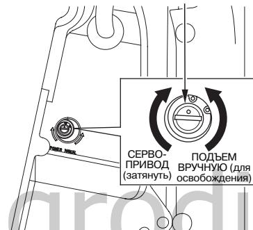
Если сервопривод подъема не функционирует (например, из-за разряженной аккумуляторной батареи или неисправного электродвигателя сервопривода), то подвесной мотор можно поднять или опустить вручную. Для этого необходимо отключить сервопривод. Для подъема подвесного мотора вручную отверните с помощью отвертки клапан отключения сервопривода на один-два оборота (против часовой стрелки). Клапан расположен под транцевым кронштейном.
