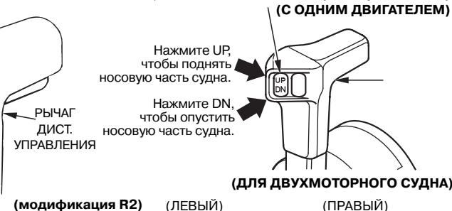
Нажмите UP, чтобы поднять носовую часть судна.
