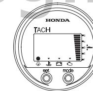
При слишком большом наклоне мотора стрелка указателя наклона будет в положении, показанном на рисунке. Для уменьшения дифферента на корму нужно уменьшить наклон мотора, нажав на сторону DN выключателя сервопривода наклона/подъёма.
