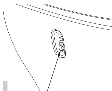
Выключатель сервопривода, расположенный сбоку на корпусе подвесного мотора, облегчает подъем мотора из воды для буксировки лодки или для осмотра и обслуживания подвесного мотора. Этим выключателем разрешается пользоваться только на неподвижной лодке и при неработающем двигателе.
