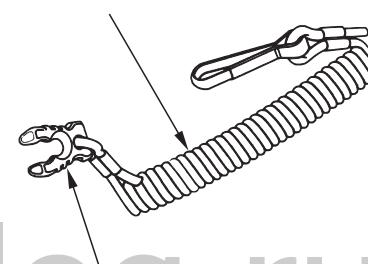
Чека аварийной остановки двигателя должна стоять на аварийном выключателе, в противном случае двигатель не запустится. При выдергивании аварийной чеки из выключателя двигатель моментально останавливается.
