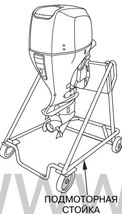
3. Закрепите подвесной мотор на стойке с помощью болтов и гаек.
