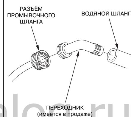
2. Отсоедините разъём промывочного шланга от двигателя.
