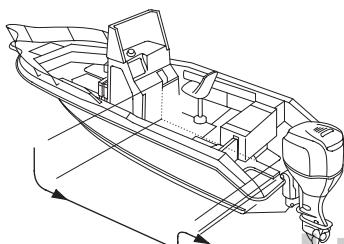
Измерьте длину трассы прокладки троса от пульта управления до подвесного мотора. Рекомендуется использовать трос, длина которого превышает измеренное значение на 300 мм. Проложите тросовый привод по предварительно намеченному маршруту и убедитесь в том, что трос имеет достаточную длину. Присоедините тросовый привод к двигателю и убедитесь в отсутствии перегибов, изгибов малого радиуса и сильного натяжения тросов, а также в отсутствии помех перемещению тросов при управлении рычагом.
