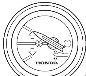
УКАЗАТЕЛЬ УГЛА НАКЛОНА
