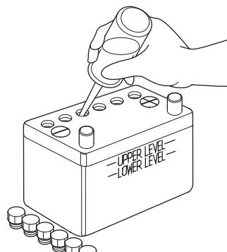
3. Долейте в аккумуляторную батарею дистиллированной воды и доведите уровень электролита до верхней метки. Запрещается превышать максимальный уровень электролита, соответствующий верхней метке.
