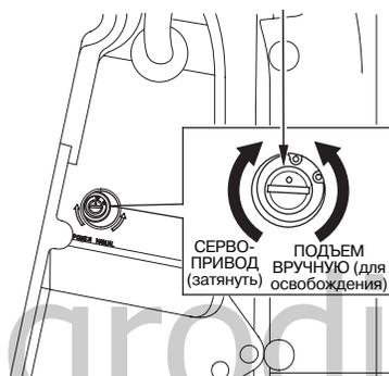
Если сервопривод подъема не функционирует (например, из-за разряженной аккумуляторной батареи или неисправного электродвигателя сервопривода), то подвесной мотор можно поднять или опустить вручную. Для этого необходимо отключить сервопривод. Для подъема подвесного мотора вручную отверните с помощью отвертки клапан отключения сервопривода на один-два оборота (против часовой стрелки). Клапан расположен под транцевым кронштейном.
