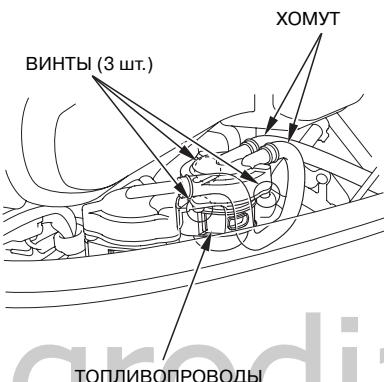
1. Снимите хомут с кронштейна отстойника, затем снимите хомут с самого отстойника.
