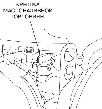
7. Установите на место и плотно затяните крышку маслозаливной горловины. Не перетягивайте крышку.
