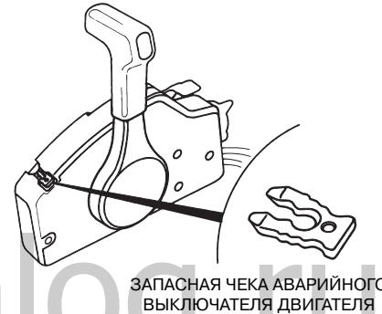
Запасная чека аварийного выключателя двигателя находится в гнезде на блоке дистанционного управления
