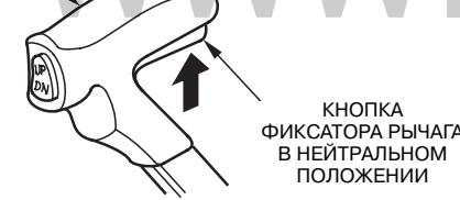
Кнопка фиксатора рычага в нейтральном положении предназначена для предотвращения случайного перемещения рычага.
